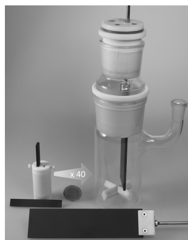
Abbildung 1. 5-mL- und 200-mL-Becherglaszellen für die Hochskalierung. Zum Größenvergleich wurde eine 2€-Münze (Durchmesser 25.75 mm, ca. 1.01 Zoll) zwischen die beiden Zellen gelegt. Weitere Details finden Sie in den Hintergrundinformationen.
