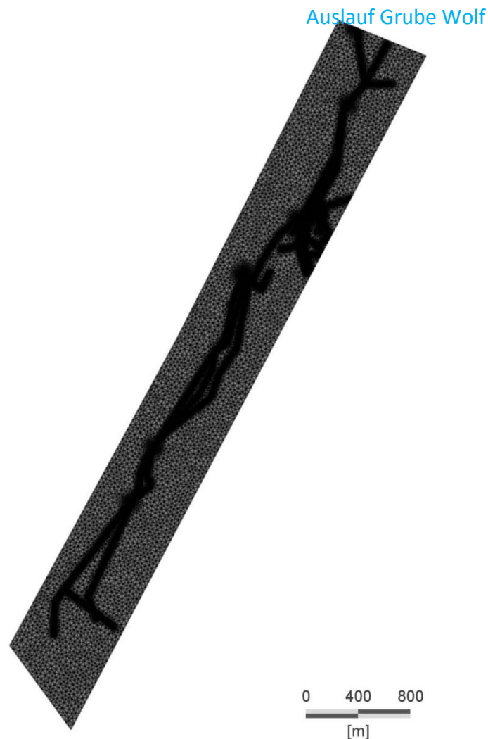
Abbildung 5-20 Finite Elemente-Gitter des Modells mit angelegten Linien- und Punktelementen (Aufsicht auf Slice 1)
