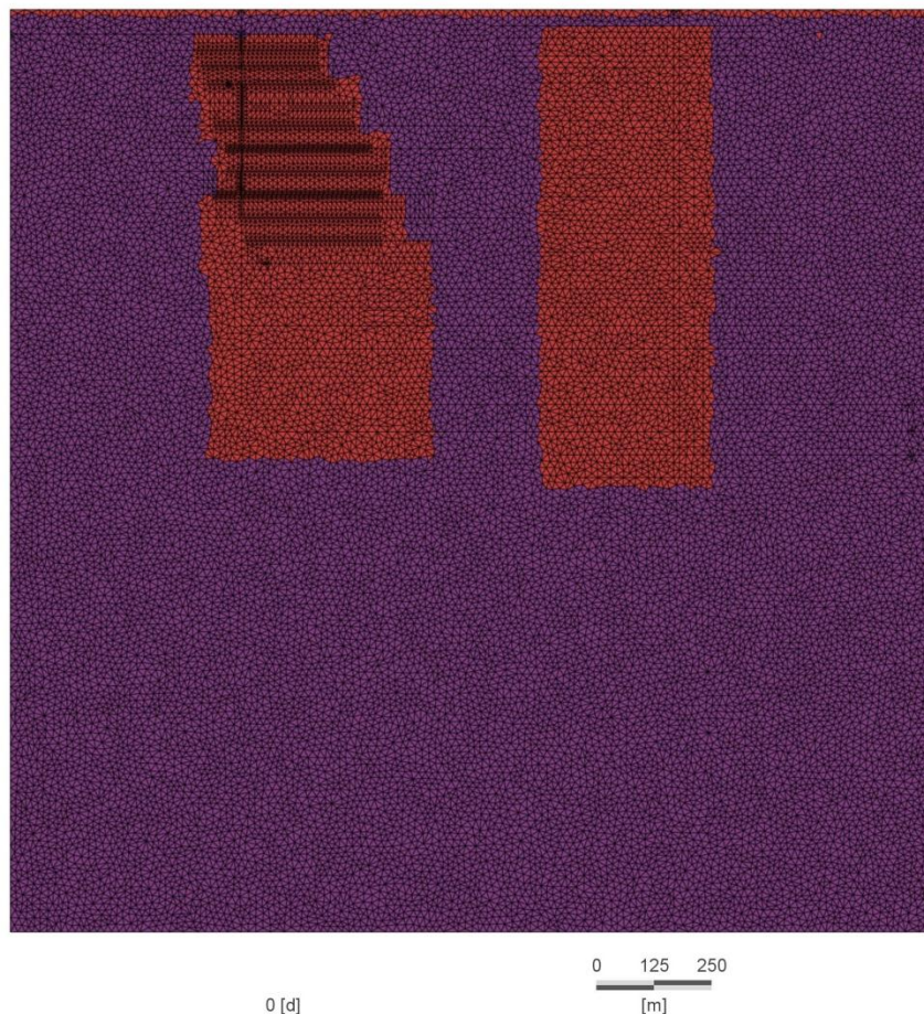
Abbildung 5-3 Position der rückversetzten Abbaubereiche und obertägigen Auflockerungszone (rot) mit, gegenüber der Matrix (violett), erhöhter Durchlässigkeit
