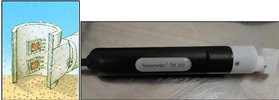
Abbildung 18 links: Aufbau der Sonde des Tewameter® TM 300 Courage &Khazaka electronic GmbH mit integriertem Sensorenpaar zur Erfassung des partiellen, atmosphärischen Wasserdampfdrucks und der Lufttemperatur; rechts: Messsonde des Tewameter® TM 300 Courage &Khazaka electronic GmbH
