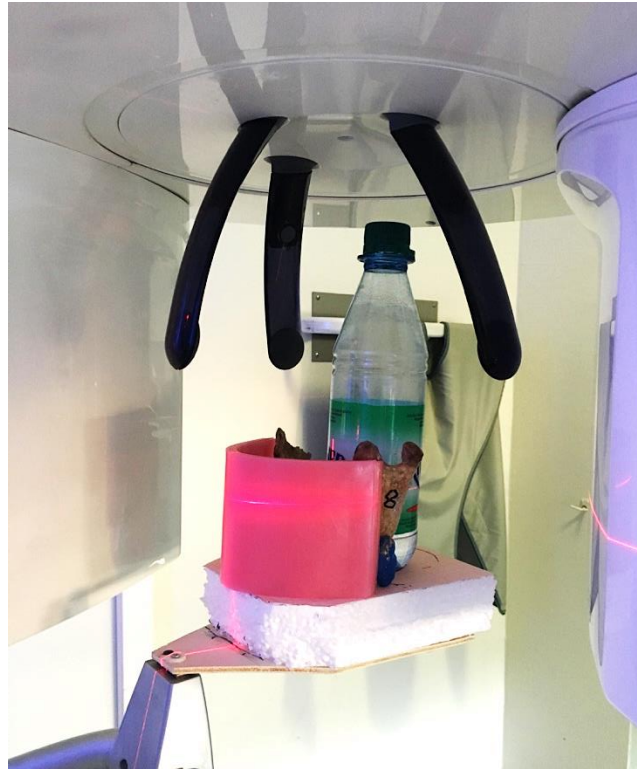
Abbildung 13: Versuchsaufbau im Orthophos SL von Sirona mit gebauter Halterung
