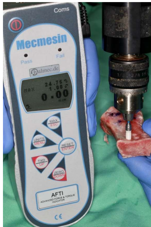
Abbildung 15: Messung der Drehmomente mit Kraft- und Drehmomentanzeigergerät „AFTI“
