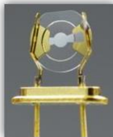
Abbildung 3: Fotografie einer 195 MHz-Quarzmikrowaage.
