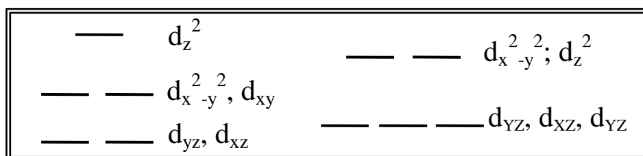
Abb.III.41. d-orbitale in trigonal bipyramidaler (links) und oktaedrischer Aufspaltung (rechts)
