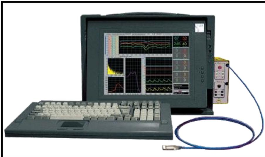
**Abbildung 3.3** Gerät mit dem Namen O2C (oxygen to see) zur Messung des dermalen Blutflusses und der postkapillären Sauerstoffsättigung (SO<sub>2</sub>) (66)
