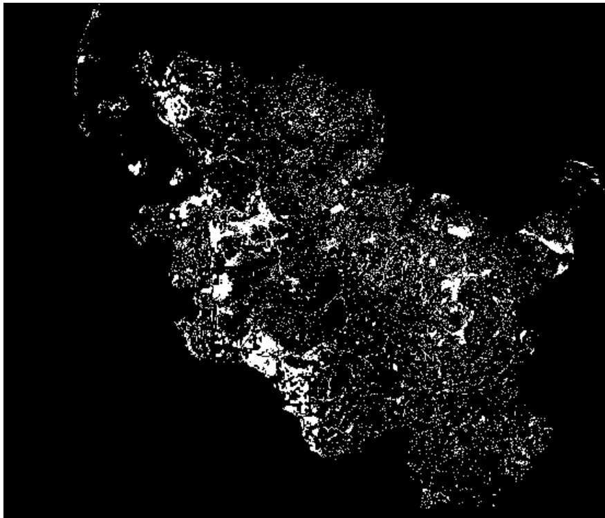
Abbildung 6-2: Binärbild der Senken, die in MATLAB mit Hilfe der DIS-Funktion berechnet wurden. Weiß entspricht den Senkenflächen, die schwarzen Flächen sind keine Senken, bzw. es fehlt ihnen eine entsprechende Höheninformation.
