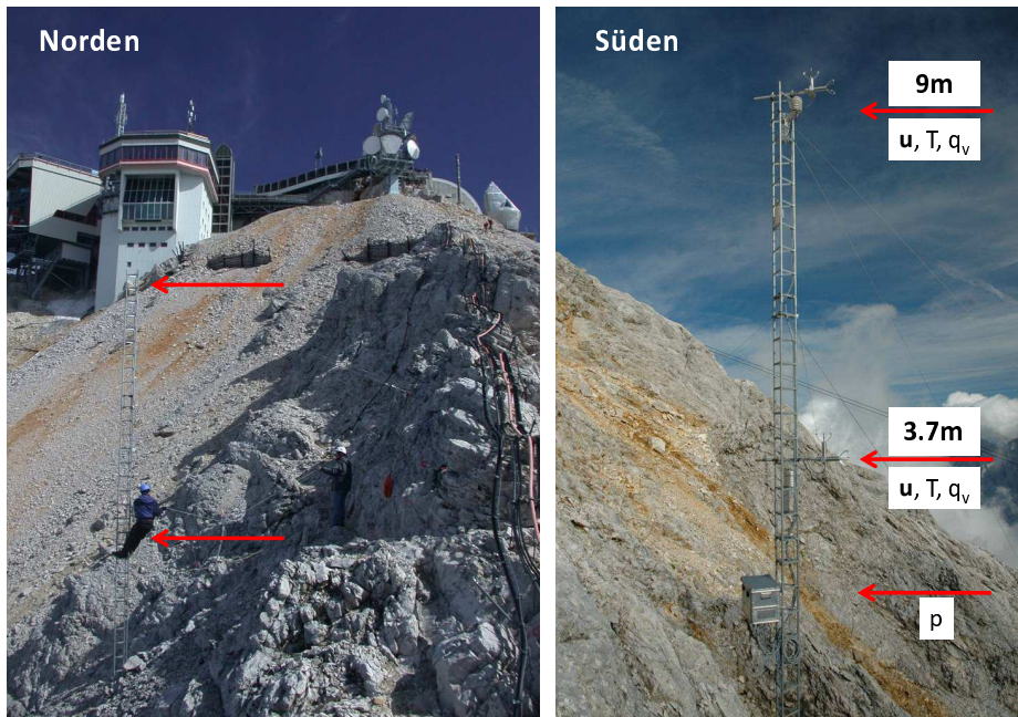
Abbildung 4.7: Messmasten auf der Nord- und Südseite des Zugspitzgrates. Pfeile kennzeichnen Messpositionen über Grund. Der Grat besitzt in diesem Bereich eine südwest–nordost Ausrichtung. Fotos: Jan Schween
