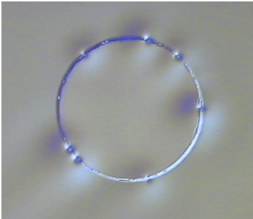
Abbildung A.2: Runder Tunnelkontakt beschichtet mit dem Negativ Photolack Su-8-2002 vor der Öffnung des Fensters als Zugang zur Gegenelektrode. An den Rändern haben sich Blasen gebildet, deren Schatten und Interferenzerscheinungen im Phasenmikroskop deutlich zu sehen sind. Zusätzlich sind in den Blasen noch einmal kleinere Blasen im Zentrum sichtbar.
