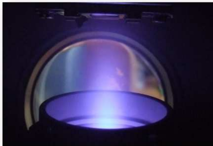
Abbildung 3.5: Kathodenzerstäuben von \text{Co}_2\text{Cr}_{0,6}\text{Fe}_{0,4}\text{Al} . Unten erkennbar ist die Kathode ohne Kamin. Oben befindet sich das Substrat. Das Argonplasma entsteht durch den Betrieb der Kathode mit Wechselspannung.
