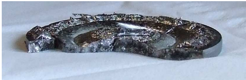
Abbildung 3.7: \text{Co}_2\text{Cr}_{0,6}\text{Fe}_{0,4}\text{Al} -Target nach seiner Verwendung. Deutlich sind Inhomogenitäten an der Bruchkante zu erkennen.
