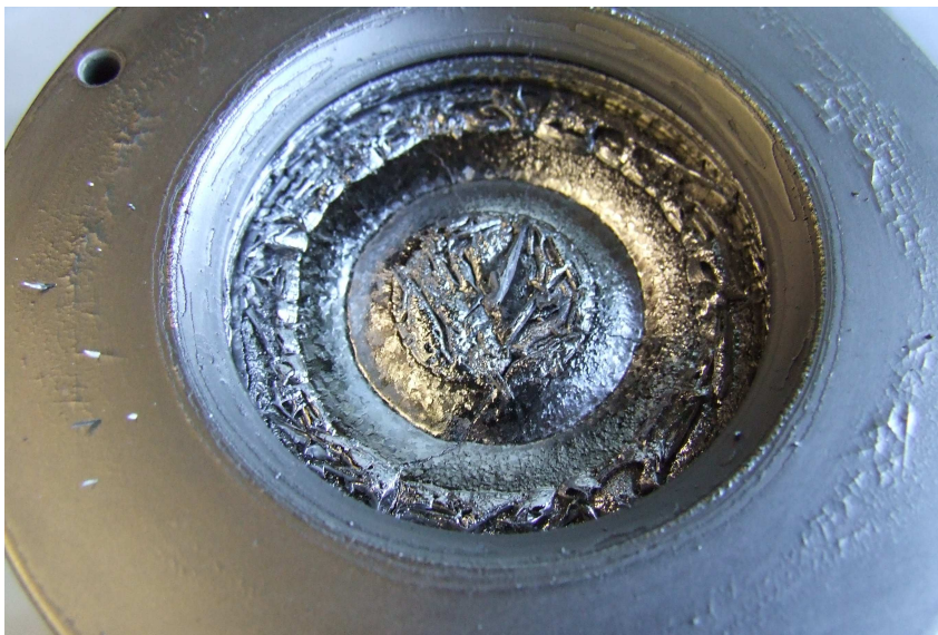
Abbildung 3.6: Verwendetes \text{Co}_2\text{Cr}_{0,6}\text{Fe}_{0,4}\text{Al} -Target in der Kathode. Der Sputterring durch die Magnetkonfiguration auf dem Target ist gut sichtbar.
