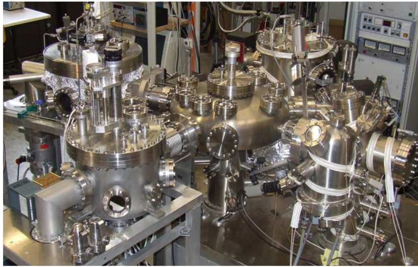
Abbildung 3.1: Präparationscluster für die Deposition heuslerbasierter Tunnelelemente. Das Cluster besteht aus zwei Sputterkammern, einer Analysekammer mit Rastertunnelmikroskop, einem Schleusensystem und einer Kammer für Elektronenbeugung, Massenspektrometer und Elektronenstrahlverdampfer. Im Vordergrund links befindet sich die neu entworfene Sputterkammer.
