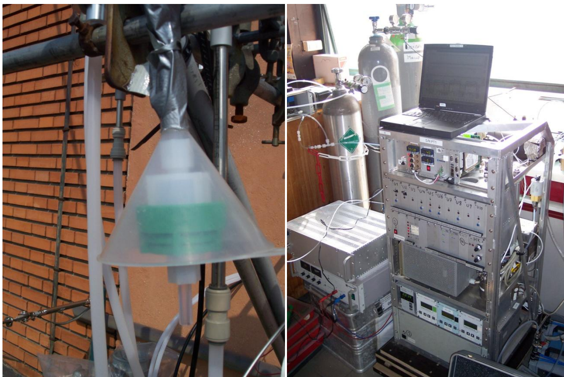
Abbildung 3.2: Aufbau des Einlasses mit Filter (Links) und das PTR-MS (Rechts).
