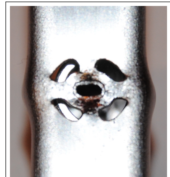
Abbildung 6.4.: Fotografie einer durch thermische Ausdehnung deformierten Ionenquelle.
