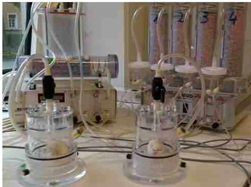
Abbildung 8: Darstellung des Ganzkörperplethysmographen-Systems der Firma BUXCO®
