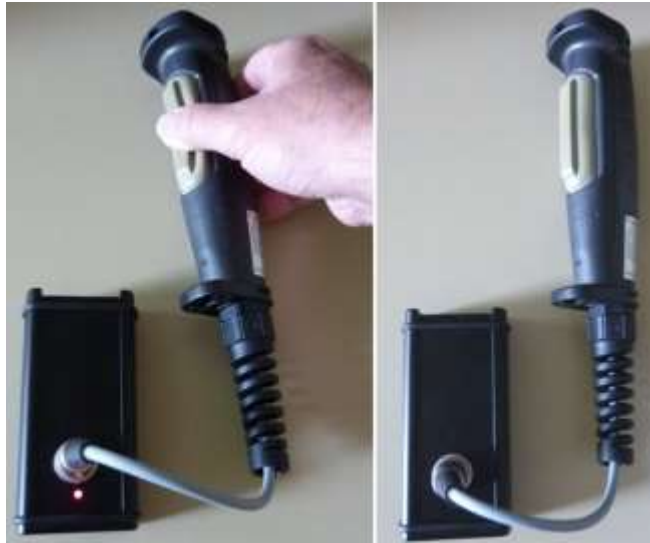
Abbildung 11 – Zustimmungstaster; in Mittelstellung (bzw. Betriebsstellung; Messung möglich, links) und Ausgangsstellung (rechts)
