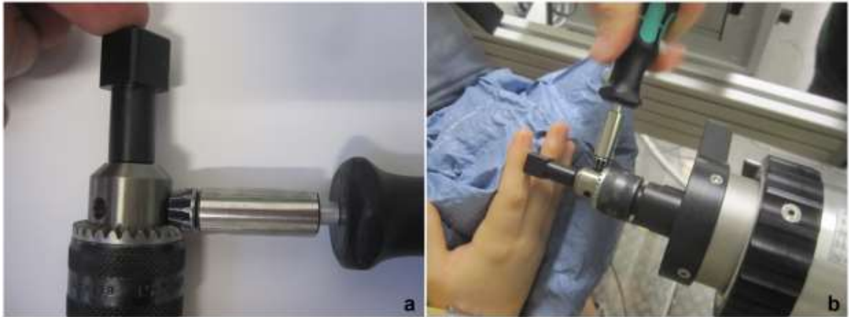
Abbildung 15 – a) Bohrfutter als Stößelhalterung; b) Adjustieren für Messung am Finger
