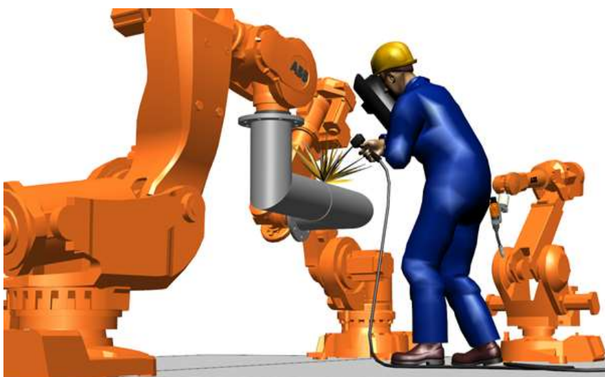
Abbildung 3 – Industrieroboter halten Teile; Quelle und Copyright: Lehrstuhl für Industrielle Robotik und Produktionsautomatisierung (IRPA), TU Dortmund Quelle des Schweißers: www.grueter.com
