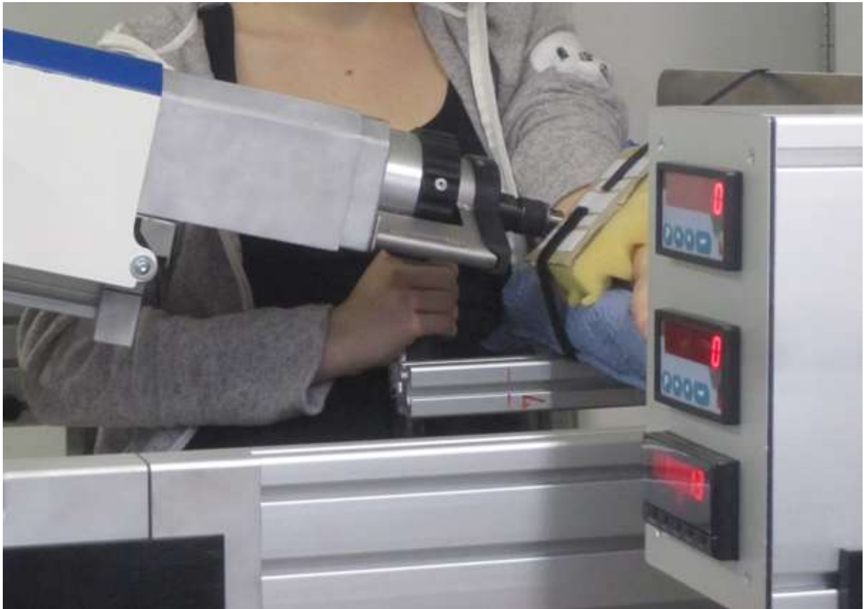
Abbildung 8 – Digitale Neigungsanzeige (rechts im Bild); Messung am N. Medianus mit 13^\circ nach unten geneigtem Algometer
