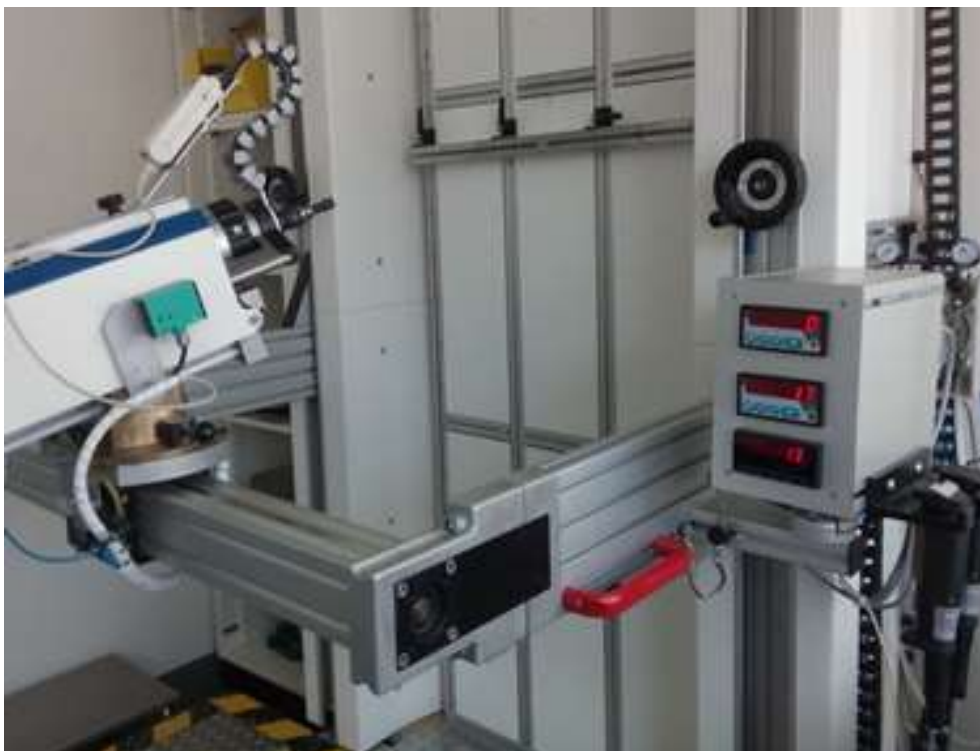
Abbildung 9 – Neigungsanzeige des um 17^\circ nach rechts sowie 13^\circ nach oben geneigten Algometers
