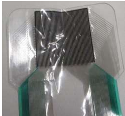
Abbildung 17 – Verformung der Druckmessfolie nach einmaliger Messung mit einem runden Stößel
