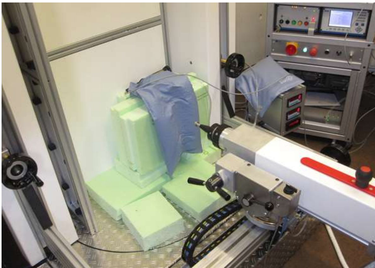
Abbildung 18 – Lagerungsmaterial: Vakuumkissen und Styroporplatten; Vorversuche
