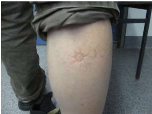
Abbildung 16 – Abdruck der Druckmessfolie auf der Haut des Probanden, runder Stößel
