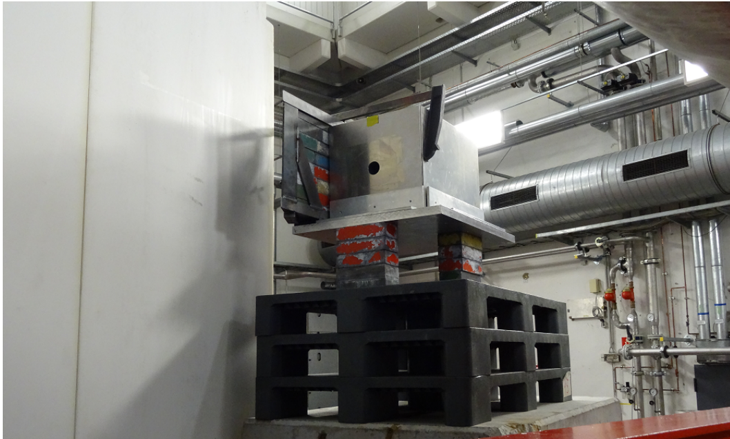
Abbildung 4.3: Photonenstrahlfänger zur Absorption von Bremsstrahlung. Das Eintrittsloch befindet sich unter 0^\circ in Strahlrichtung und auf Strahlhöhe. Auf der KAOS zugewandten Seite ist eine zusätzliche Bleiwand festgeklemmt, um ihn als Quelle für zusätzlichen Untergrund auszuschließen.
