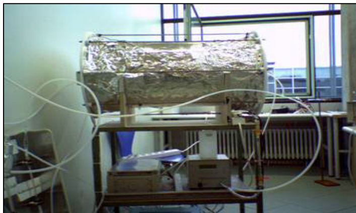
Abb. 2.1.1.1: Verwendete abgedunkelte 100 L Reaktionskammer für die Ozonolyse einzelner VOCs
