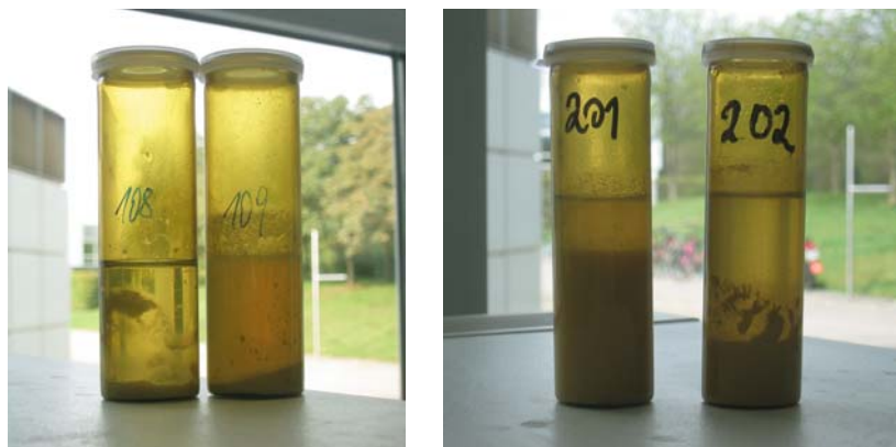
Abbildung 24: TiO 2 -Partikelherstellung mit niedermolekularen Tensiden
