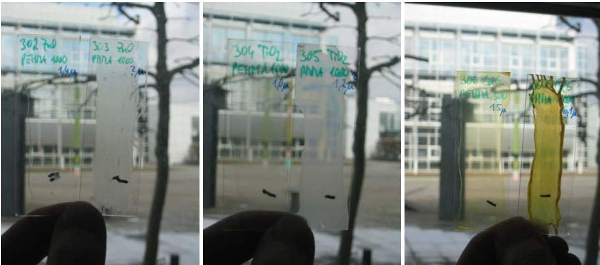
Abbildung 86: Nanokompositfilme; Jedes Foto zeigt links die PEHMA- Matrix, rechts die PMMA-Matrix.
