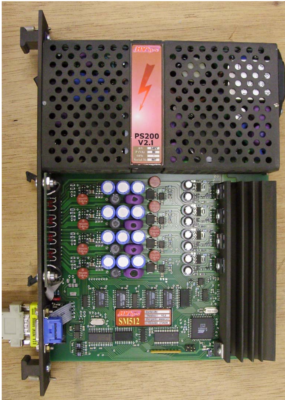
Abbildung 6.3: Netzteil und Steuergerät der HV512 Hochspannungsvorsorgung. Das Modul passt in einen 6U Europarahmen und wird mit 220V versorgt. In der Mitte der linken Seite ist der Anschluss für das Flachbandkabel zu den vier „Ästen“. Der darunter befindliche 9pol. SubD Anschluss dient der Ansteuerung über eine serielle RS232-Leitung von einem Computer aus.
