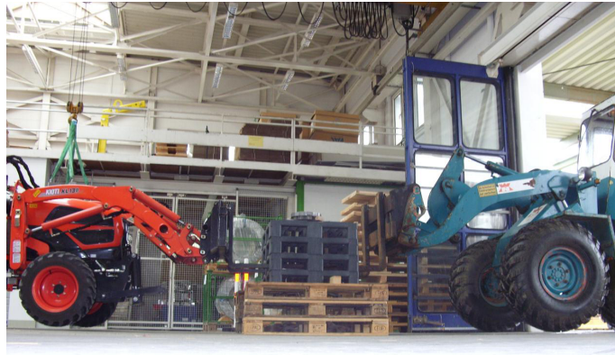
Abbildung A.9.: Fixierung des unteren Magnetteils mit Hilfe von massiven Hebemitteln kurz vor der Endmontage.
