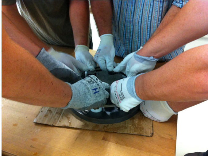
Abbildung A.3.: Verklebung der Magnete auf einer der Polplatten.
