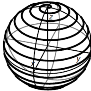
Abbildung 2.4.: Nutation des Kernspins: Die Spur, die von der Spitze des Spinpolarisationsvektors bei Anwendung eines RF-Pulses im Laborsystem hinterlassen wird. Diese Abbildung verwendet unrealistische Parameter, um die Natur der Bewegung klarer darzustellen. In der Realität dreht der Spinzustand mehrere tausend mal um die z-Achse während der Drehung um die x-Achse. [18]
