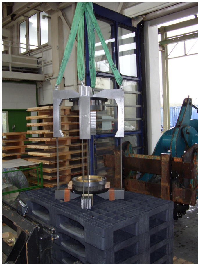
Abbildung A.10.: Endmontage des Magneten. Der untere Teil des Magneten wurde auf Paletten mit Bandschlingen fixiert und mit zwei Gabelstaplern beschwert. Der obere Teil wurde mit Hilfe eines Krans und Gewindestangen zur Führung der Seitenjochs auf den unteren Teil abgesenkt. Die zu beherrschenden Kräfte kurz vor dem Zusammenschluss des Ober- und Unterteils betragen fast 20 kN.
