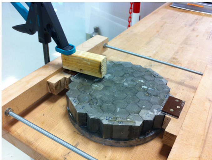
Abbildung A.4.: Fixierung der letzten beiden Magnete. Zur Aushärtung wurde die Platte in einer Art Schraubstock verklemmt. Aufgrund der magnetischen Kräfte konnten pro Tag nur zwei Magnete auf diese Weise verklebt werden.
