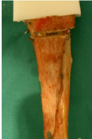
Abbildung 27: Präparat mit XSCREW nach Belastung: radiale Fissur
