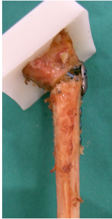
Abbildung 18: Präparat mit DNP nach Belastung: Palmares Abkippen
