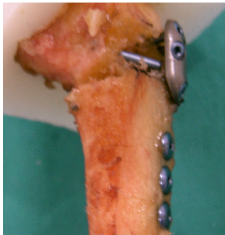
Abbildung 19: Präparat mit DNP nach Belastung: aus dem Knochen gezogene Pegs
