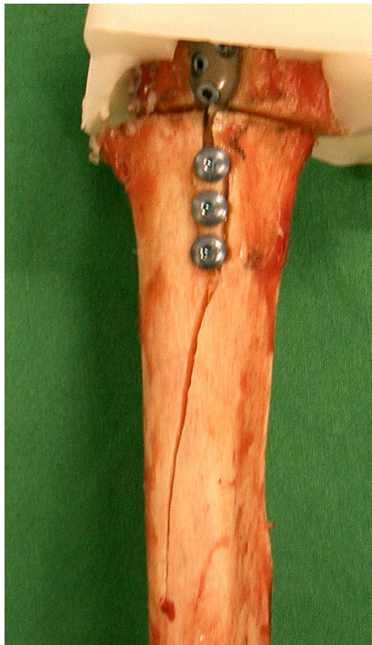
Abbildung 17: Präparat mit DNP nach Belastung: Dorsale Fissur
