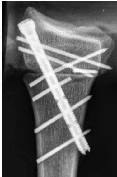
Abbildung 30: Präparat mit XSCREW nach Belastung: Drahtbruch
