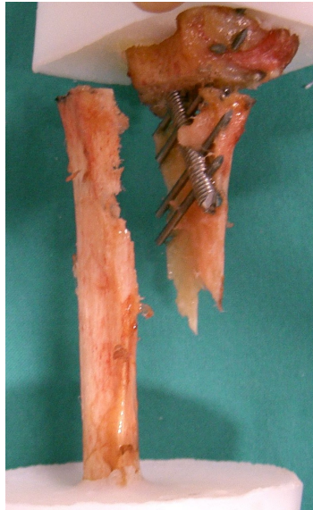
Abbildung 29: Präparat mit XSCREW nach Belastung: komplette Spaltung
