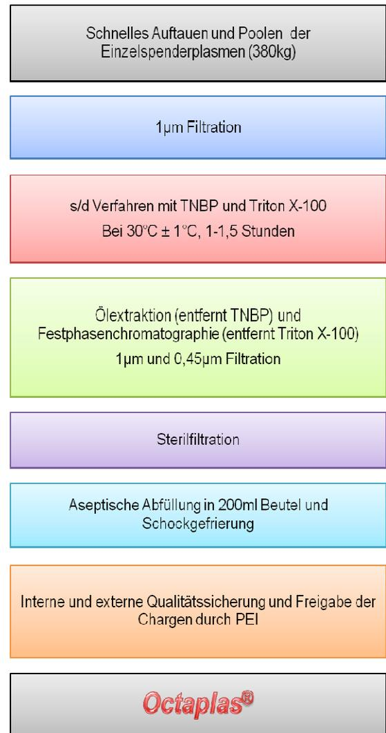
**Abb. 4:** Herstellung von solvent/detergent behandeltem Plasma. Aus (49).
