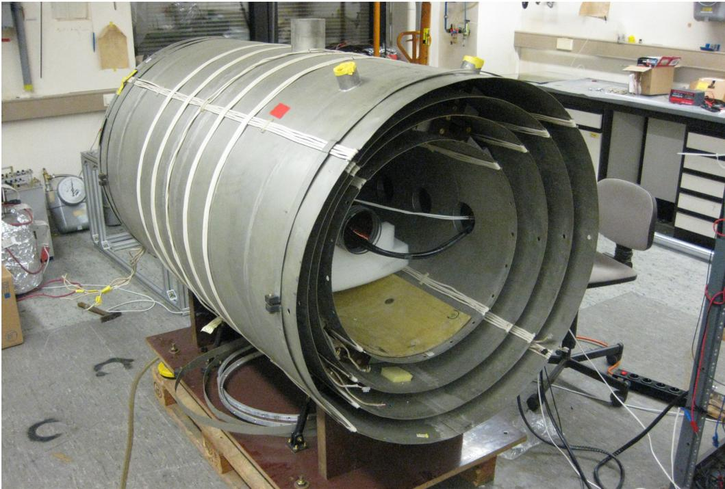
**Abbildung 6.2.:** 4-lagiges Mumetallschild nach der Anlieferung vom PSI im November 2010. Die Stülpedeckel der einzelnen Mumetall-Lagen sind abgenommen. Die Entgaußungsspulen sind als weiße Kabel zu erkennen.
