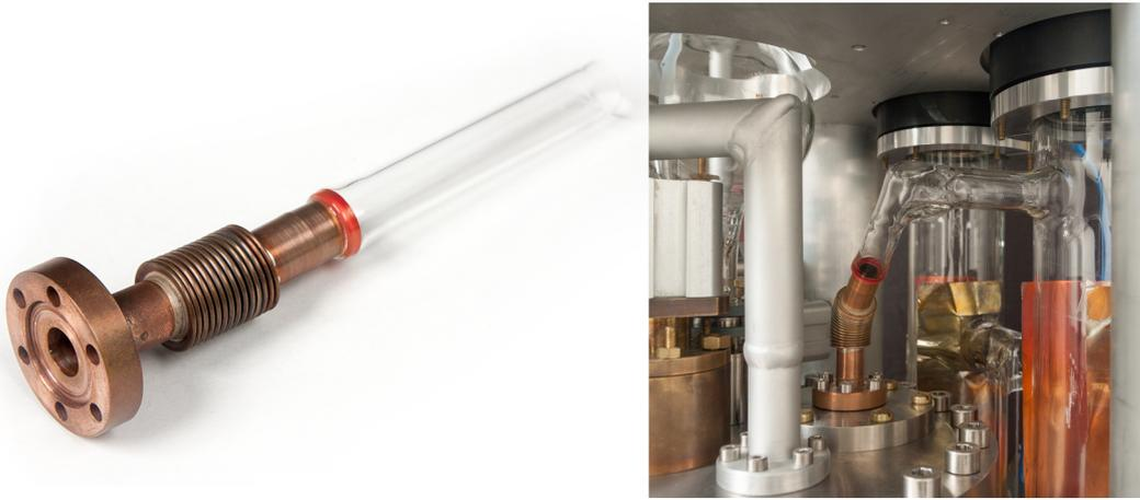
**Abbildung 7.6.:** Links: Glas-Kupferbalg-Verbindung zum spannungsfreien Anschluss der Pumpzellen an Einlassventil und Kompressorkopf. Rechts: Verbindung der optischen Pumpzellen zum Kompressorkopf.
