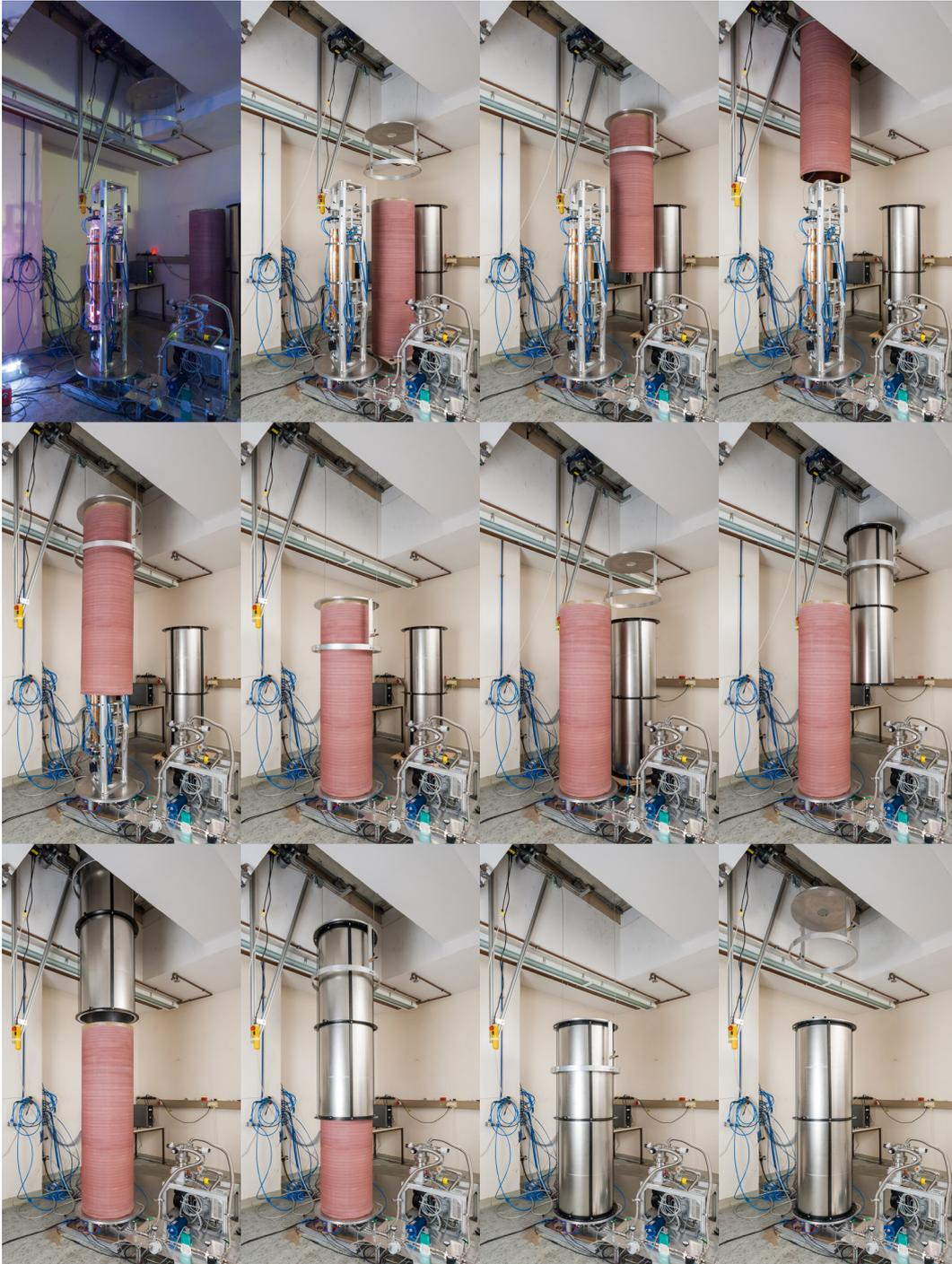
Abbildung 7.18.: Montage von Spule und Abschirmung mit Hilfe des Hebe- und Verschiebemechanismus.
