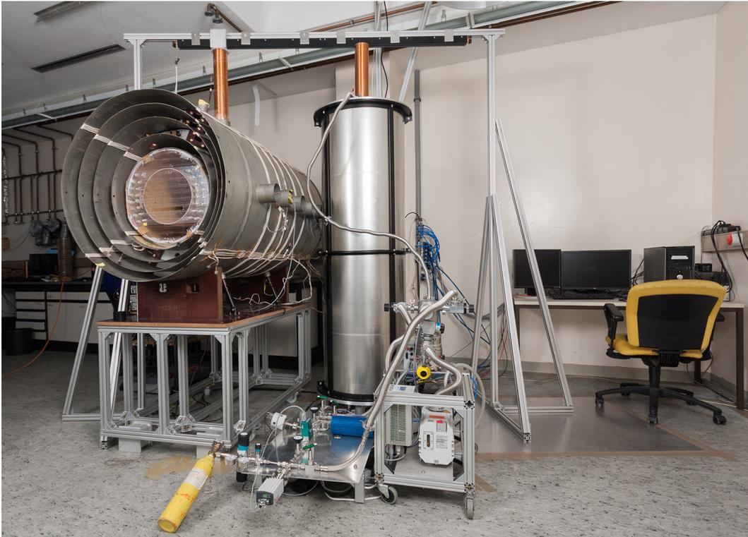
**Abbildung 8.9.:** Gesamtaufbau des Transfersystems nach Montage aller Teilkomponenten. Die vier Stülpdeckel des Testschildes sind bei diesem Bild abgenommen.
