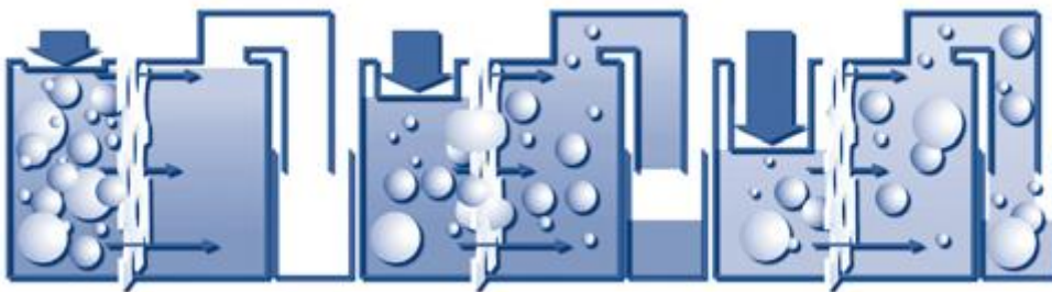
Abbildung 5: Blutreinigung der CVVH mittels Konvektion (45). Über einen Druckgradienten werden im Blut gelöste Teilchen durch die Dialysemembran in das Filtrat überführt.
