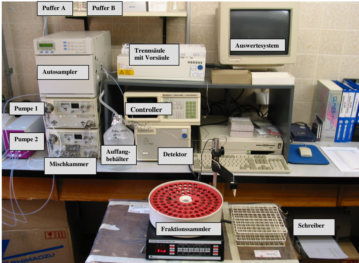
Abb. 5: HPLC-Anlage mit UV/Diodenarray-Detektor.
