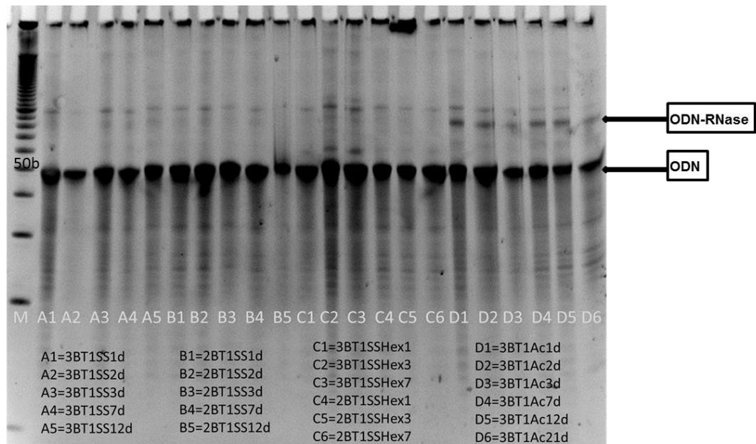
**Abbildung 4-7: Denaturierende, 20 % PAGE Analyse der Konjugation von CPG-ODN-NHS-Ester mit Benzylmercaptan für einen Tag und anschließender NCL mit der RNase „Cys-ZFY-6-Acm“ bzw. einem Hexapeptid bei unterschiedlichen Reaktionsparametern.**
