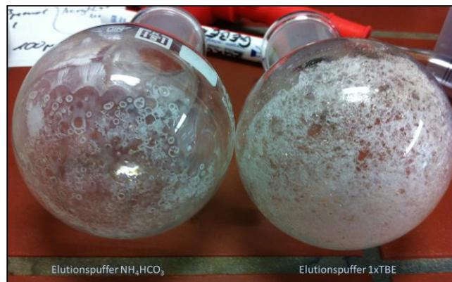
**Abbildung 4-23: Vergleich der beiden Elutionspuffer und deren Salzurückstand nachdem das Wasser abgedampft wurde**
