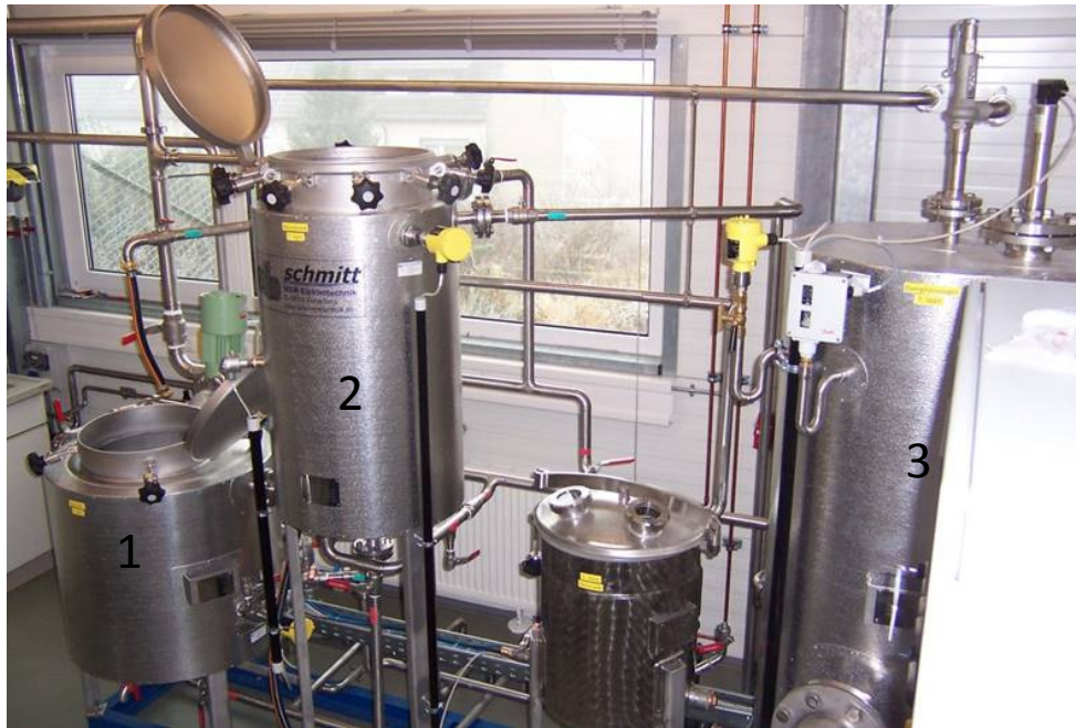
Abb. 2.1: 125 L TDH Anlage zur Thermodruckhydrolyse von Weizenstroh mit dem Flüssigkeitsbehälter (1), Druckbehälter (2) und Dampferzeuger (3).
