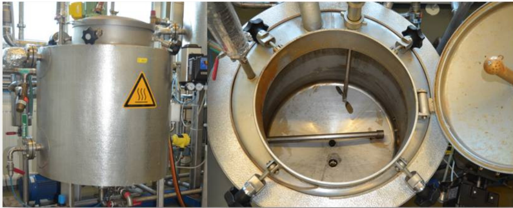
Abb. 3.28: 100 L Rührreaktor für die enzymatische Hydrolyse von TDH-Stroh (links Außenansicht und rechts Innenansicht) mit Propellerrührer und Druckluftlanze.
