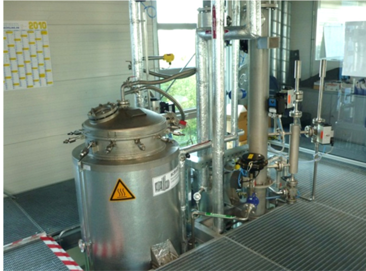
Abb. 2.2: 425 L TDH-Druckreaktorbehälter einer halbertechnischen TDH-Aufschlussanlage für Biomasse.
