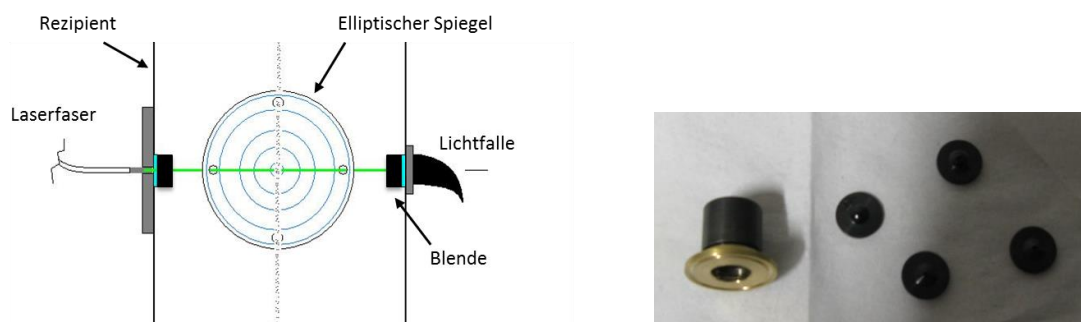
Abbildung 2.5: Links: Schematische Darstellung der Detektion mit eingesetzten Blenden vor die Fenster des Rezipienten zur Verminderung des Streulichts [modifiziert nach (Brands, 2009)]. Der PMT befindet sich in der Blickrichtungsebene. Rechts: die eingesetzten Blenden.
