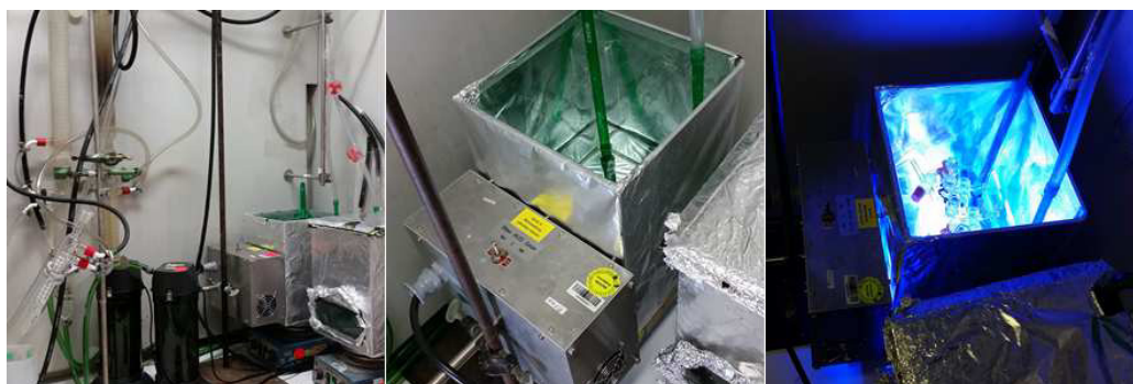
Abbildung 6.1: Experimenteller Aufbau für die mit HP-LED-blau bzw. HP-LED-grün durchgeführten Photoreaktionen.
