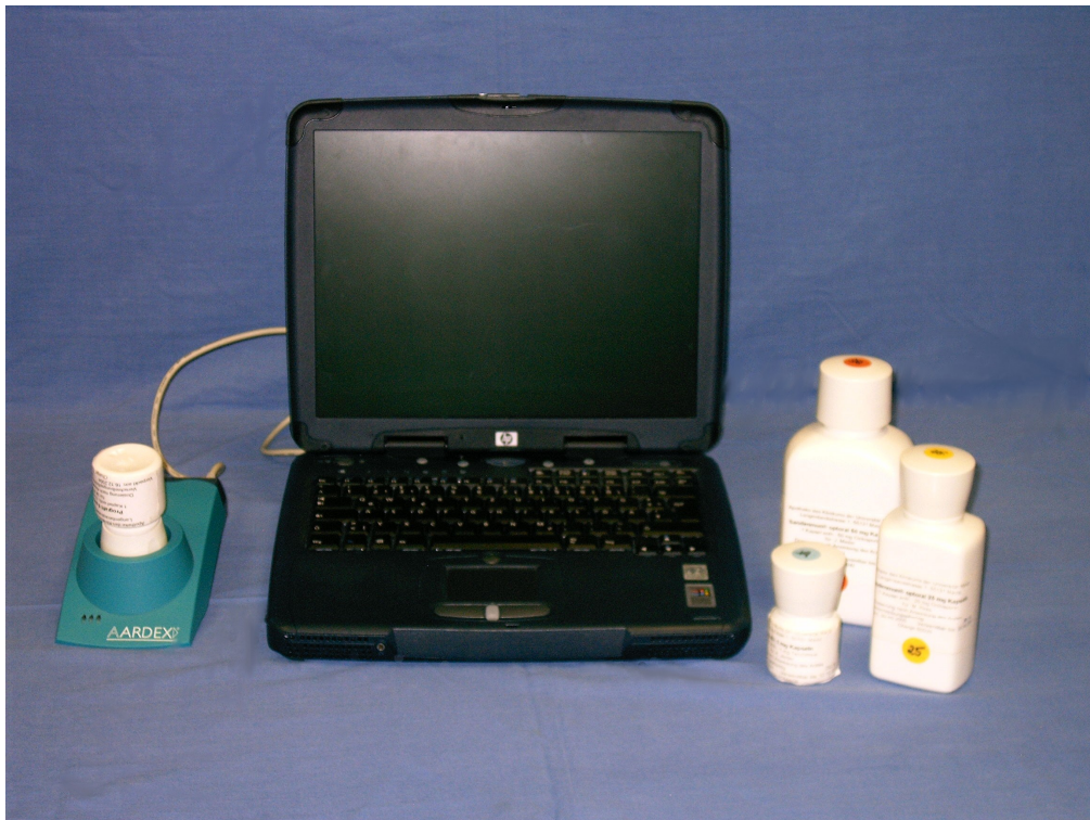
Abbildung 1.2. / 1: MEMS® (links im Bild: Datentransfer über den sog. Kommunikator; rechts im Bild: MEMS® -Behälter in verschiedenen Größen)
