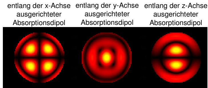
Abbildung 51: Berechnete Fluoreszenzmuster von Chromophoren verschiedener Ausrichtung bei Anregung mit y-polarisiertem Licht
