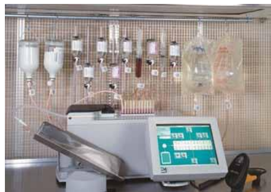
Abb. 1. Exactamix EM 2400 Compounder der Firma Baxter [12]
