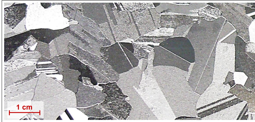
Abbildung 5.1: Multikristallines Silizium, angeätzt.
