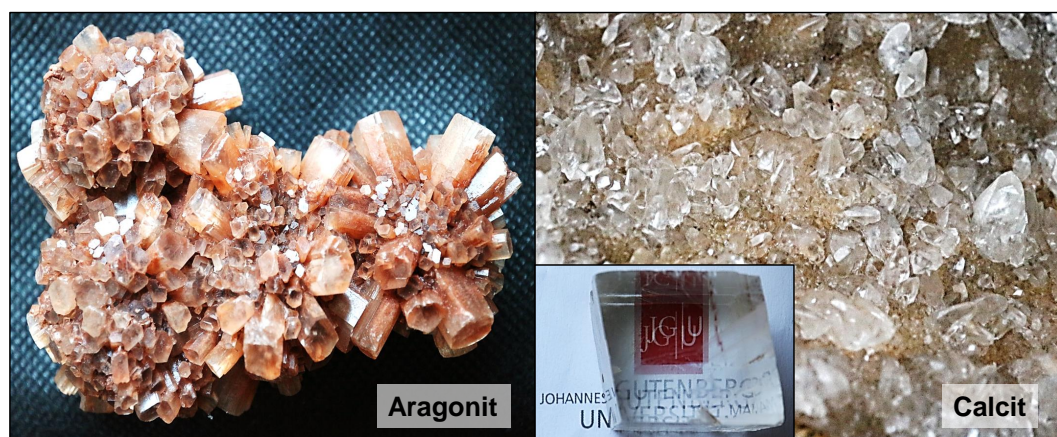
Abbildung 4.3: Links: eine Form des Minerals Aragonit; rechts: Calcit; im kleinen Bild: ein Stück eines größeren Calcitkristalls, Doppelbrechung zeigend.
