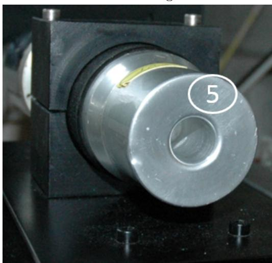
Abbildung 5.12: NaI-Detektor mit Bohrloch.
