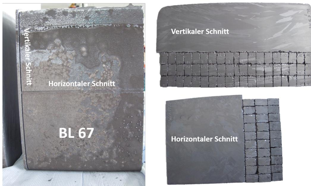
Abbildung 5.4: Horizontale und vertikale Scheibe des G2-Blocks 67 (l.) und Siliciumproben des vertikalen (r.o.) und horizontalen (r.u.) Schnitts.
