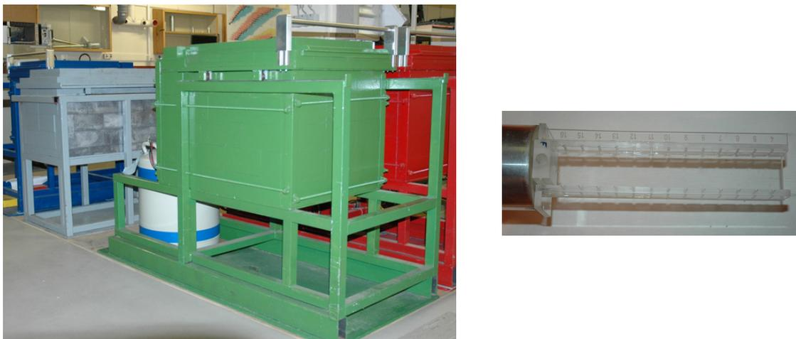
Abbildung 5.8: Links: Äußere Bleiburg von Detektor Grün, im Hintergrund steht Detektor Grau. Rechts: Probenpositionen mit Probenhalter, links ist der Detektorkopf zu sehen.
