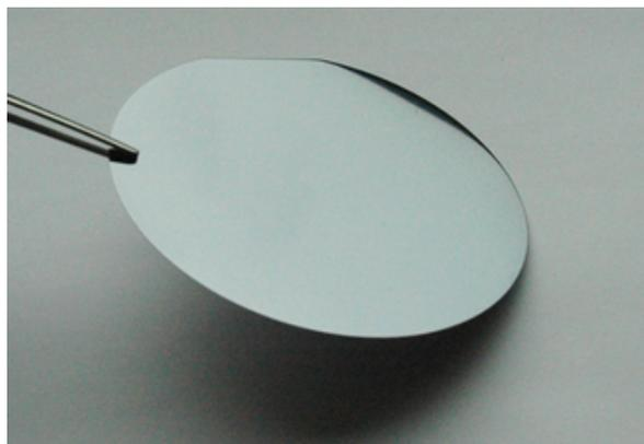
Abbildung 5.6: Typischer Wafer vom Fraunhofer ISE
