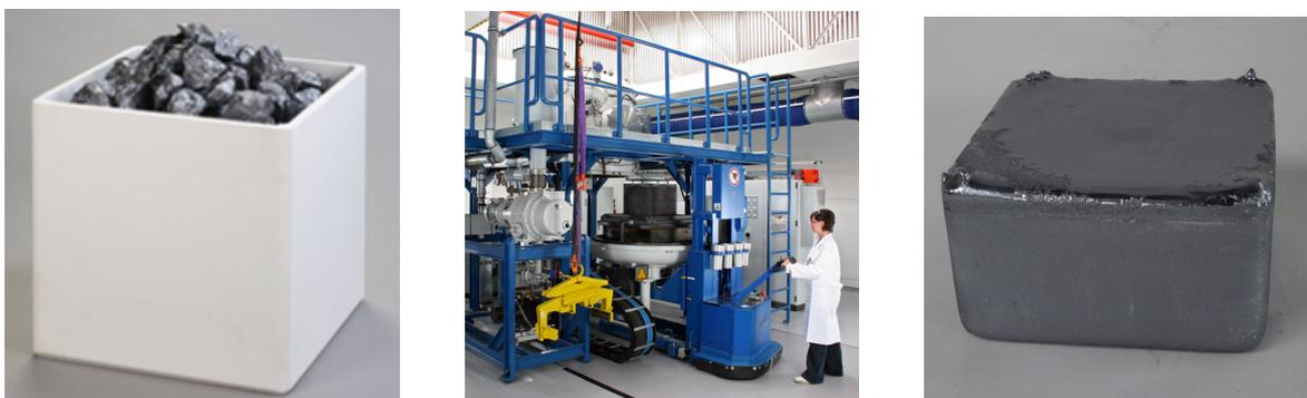
Abbildung 3.1: Schritte der gerichteten Erstarrung am Fraunhofer ISE (v.l.n.r.): Tiegelsystem mit Feedstock, VGF Ofen am Fraunhofer ISE, fertiger Si-Ingot (Bl68). (Die Bilder wurden bereitgestellt durch das Fraunhofer ISE.)
