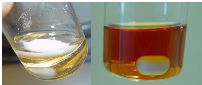
Abbildung 64. Links: [MMIM][OAc] mit ungelöster, reiner Cellulose; rechts: [MMIM][OAc] mit vollständig gelöster Cellulose.
