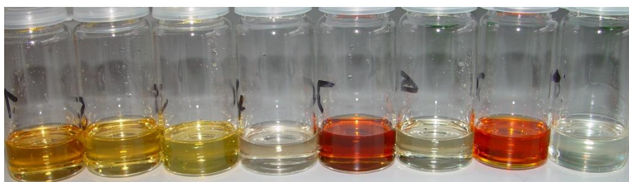
Abbildung 61. Löslichkeitsversuch mit v.r.n.l.: [BMIM][DCA], [OMIM][DCA], [BzMIM][DCA], [EMIM][OTf], [OMIM][OAc], [MMIM][Me 2 PO 4 ], [EMIM][OTs], [EMIM][OAc].
