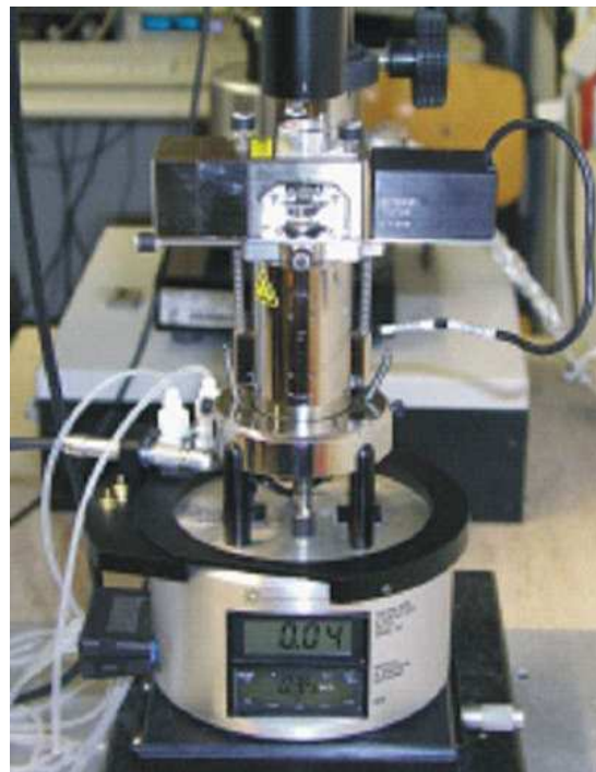
Abbildung 8.3.2: Das Rasterkraftmikroskop Multimode Tuna/Torsion zur Vermessung von Oberflächen in wässriger Lösung. Proben werden auf AFM-Specimen mit einem Durchmesser von 1 cm präpariert. Es muss in einer speziellen Flüssigkeitszelle gemessen werden.
