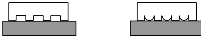
Abbildung 37: links: Der Stempel sollte so auf dem Substrat aufsitzen, daß die Kanäle durchlässig sind; rechts: bei zu geringem Aspektverhältnis oder zu starkem Druck auf den Stempel kommt es zum Durchhängen der Kanäle
