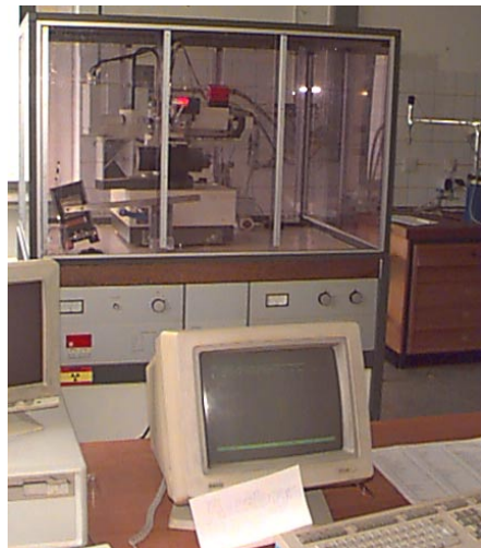
Abb. 4-5: Übersichtsaufnahme des CAD4-Einkristalldiffraktometers (Hintergrund) mit der Steuerkonsole (Vordergrund).
