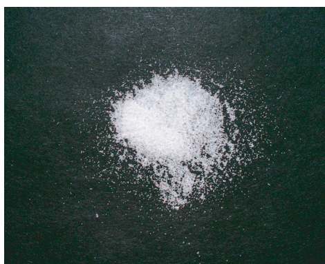
Abbildung 4.16: Abbildung des Produktes PP20 (4 bar, 50° C, 30 min, divinylbenzolvernetzter Träger). Auf Grund der gehinderten Fragmentierung des divinylbenzolvernetzten Trägers wurden nur kleine, etwa 0,2 mm große, aber relativ harte Partikel gebildet.
