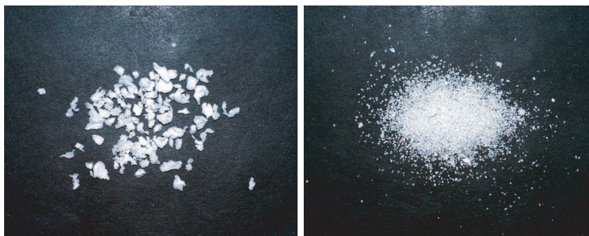
Abbildung 5.5: Abbildung der Produkte PE17 (Teilchendurchmesser etwa 5 mm) und PE18 (Teilchendurchmesser etwa 0,3 mm). Beide wurden mit dem gleichen Katalysator unter identischen Bedingungen hergestellt. Während die Katalysatorpartikel bei PE17 (links) besonders groß waren, wurde der Katalysator bei PE18 (rechts) vor der Polymerisation fein vermahlen.
