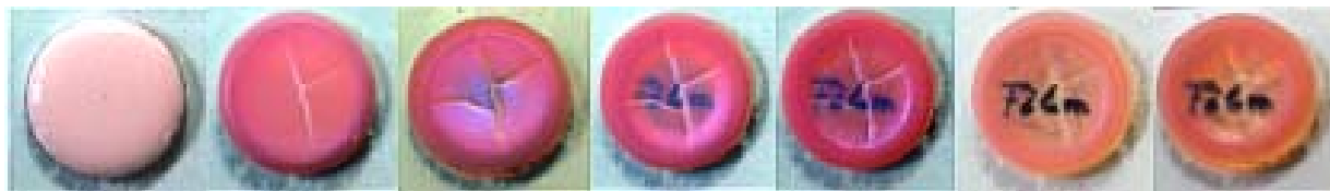
Abbildung 2.8: Trocknungsmorphologie einer Probe von P_{200}(BMA)_{100} auf einer Quarzglasplatte ( \varnothing = 2 cm) bei einer Temperatur von 40^{\circ}\text{C} . Zur Erzielung eines besseren Kontrastes ist die Probe mit gefärbtem ACR vermischt. Um die Transparenz der Probe zu beurteilen, wurde unter den Probenhalter das Wort Film geschrieben. Deutlich sichtbar ist die an der Peripherie entstehende Verdickung.
