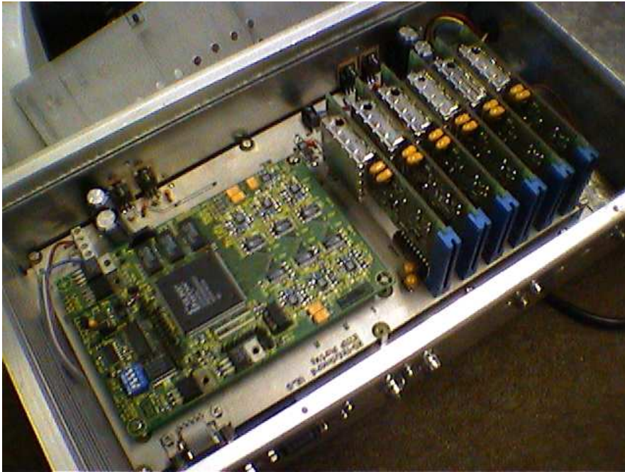
ABBILDUNG 3.7. Die neue Ausleselektronik für die Flüssig-Argon-Reinheitsmessung.
