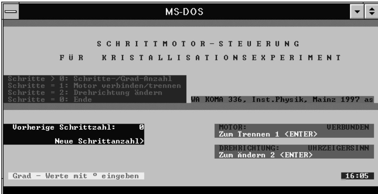
**Abb. 8.14:** Benutzeroberfläche des Programms STEPMOT. Durch Eingabe der Schrittzahl und Angabe des Drehsinns kann der Detektorarm an jede beliebige Position gefahren werden.
