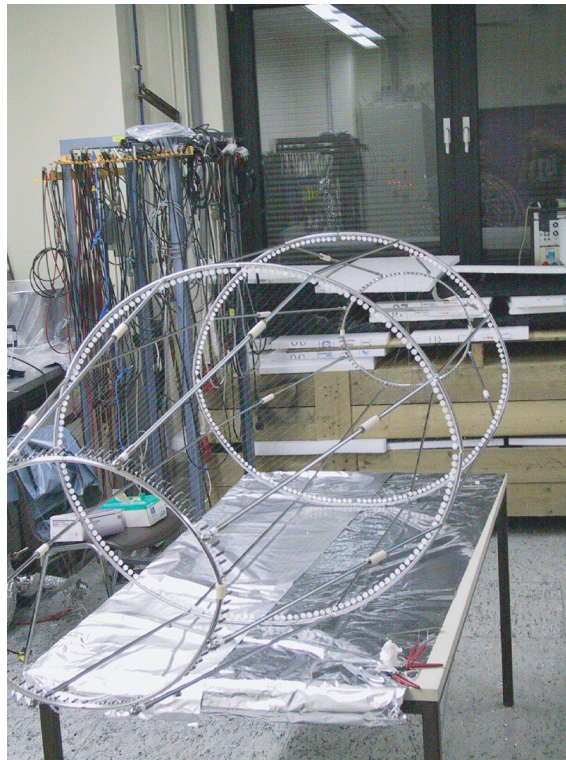
Abbildung 7.2: Die Drahtelektrode bei einem Testaufbau vor dem Einbau ins Spektrometer.
