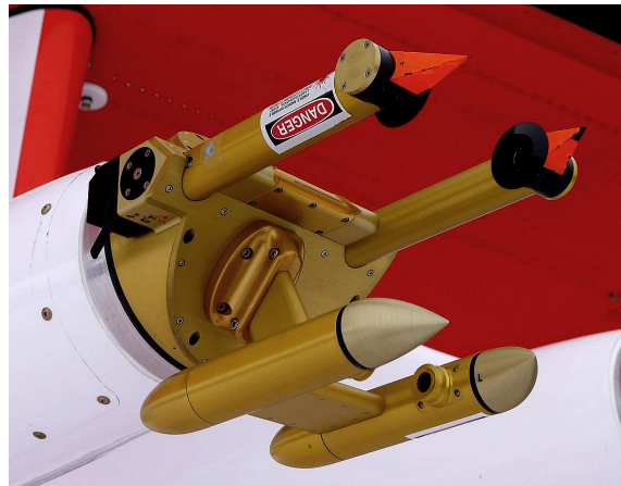
Abb. 1.1: CCP-Sonde: der untere Ausleger ist das CDP-Instrument und beinhaltet den Partikel-Streulichtdetektor (Cloud Droplet Probe mit der FSSP-Messtechnik). Zwischen den oberen Ausleger-Armen befindet sich das Messvolumen des bildgebenden CIP-Instruments (Cloud Imaging Probe).
