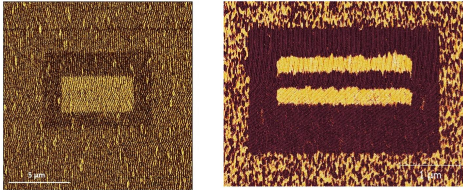
Abbildung 3.22: Bilder der PFM-Phase einer Piezokraft-Lithographie von zwei BFO (80 nm)/LSMO (20 nm)/STO-Proben, deponiert von einem stöchiometrischen (links) und einem nicht stöchiometrischen (rechts) Target.
