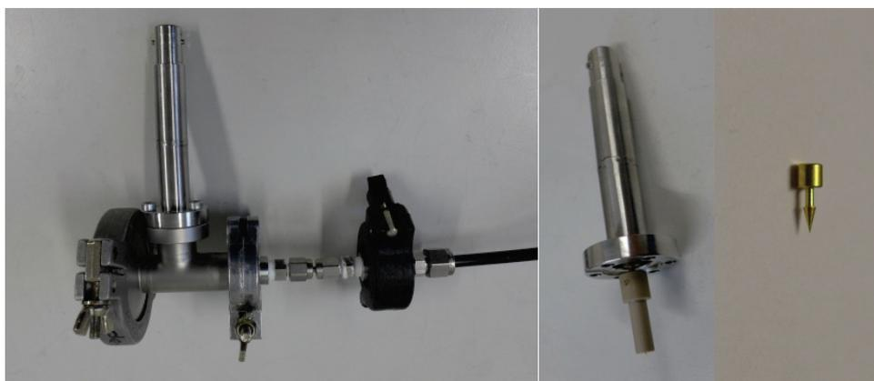
Abbildung 3.9: Links: Gesamtaufbau der Gasentladungsquelle mit angeschlossener Einlassleitung. Mitte: Hochspannungsdurchführung mit montierter PEEK Halterung für die Goldnadel. Rechts: Goldnadel.
