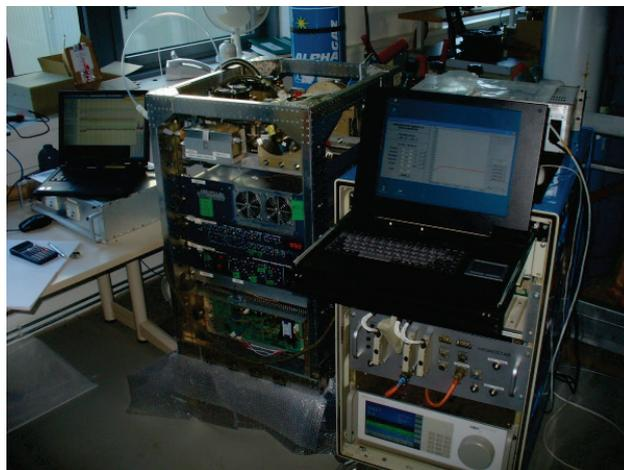
Abbildung 3.21: Foto des Laboraufbaus. Rechts sieht man den Feuchtestand HygroStar mit dem MBW 373LX Taupunktspiegel als unterstem Einschub, in der Mitte ist AIMS-H<sub>2</sub>O im Falcon Rack zu sehen.
