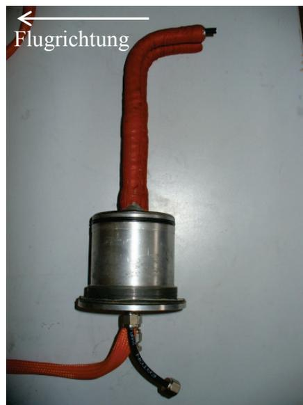
Abbildung 3.45: Lufteinlass für die Wasserdampfmessung mit AIMS-H<sub>2</sub>O auf der Falcon. Das Synflex Rohr ist komplett durch den Einlass geschoben, an der unteren Swagelok Verschraubung ist im Flugzeug ein Absperrventil zur Verriegelung der Einlassleitung angeschraubt.
