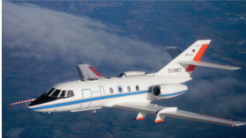
Abbildung 4.1: Forschungsflugzeug Falcon des DLR. An dem Flügel sind zwei angebaute Sonden zur Messung von Aerosolen zu sehen. An der Oberseite der Kabine sind die Lufteinlässe zur Versorgung der Instrumente in der Kabine angebracht. (Quelle: DLR)
