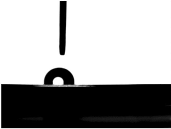
Abbildung 26: Wassertropfen auf einem unbehandelten Substrat.
