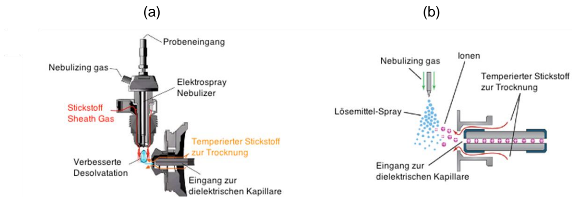
Abbildung 41: Aufbau der Elektronenspray Ionenquelle mit der Agilent Jet Stream Technologie (a) und orthogonaler Einleitung des Lösungsmittelstroms (b).
