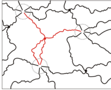
Abbildung 2 – Illustration des Wirkungsprinzips eines Assoziativverdickers.
