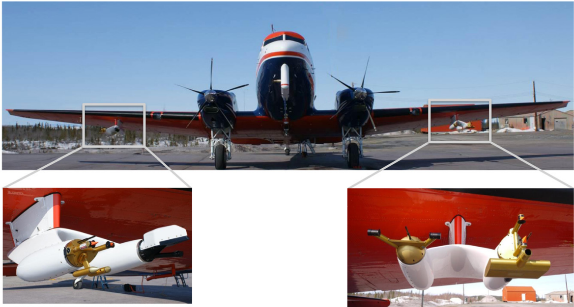
Abbildung 3.12 – POLAR 5 mit montierten Flügelsonden. Zu sehen sind (von links nach rechts) CCP, SID-3, PIP und NIXE-CAPS (Fotos bereitgestellt von E. Bierwirth (LIM)).
