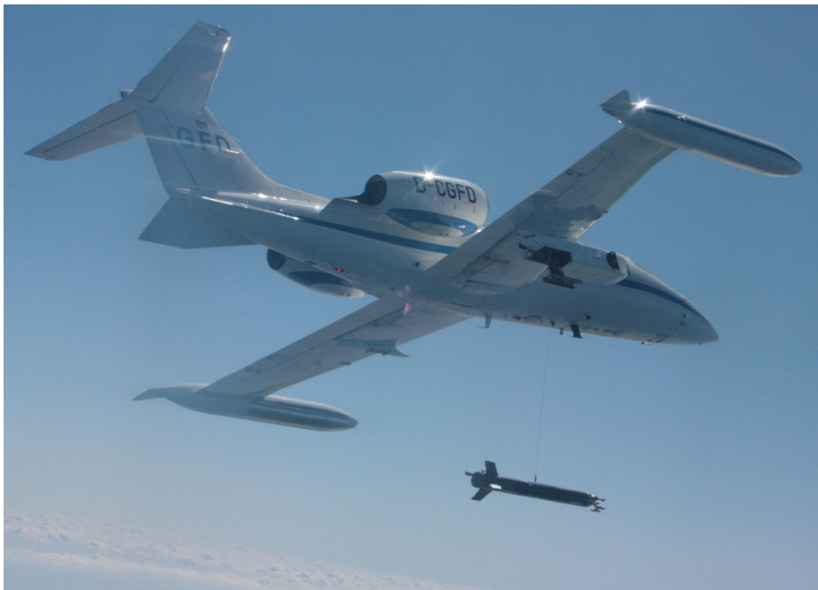
Abbildung 2.1 – Lear-Jet mit herabgelassenem Schleppkörper. Der Schleppkörper ist mit mikrophysikalischen, meteorologischen und solaren Strahlungs-Messinstrumenten bestückt. Betrieben wird diese Tandem-Messplattform von der Gesellschaft für Flugzieldarstellung (GFD) sowie von der Firma enviscope GmbH .
