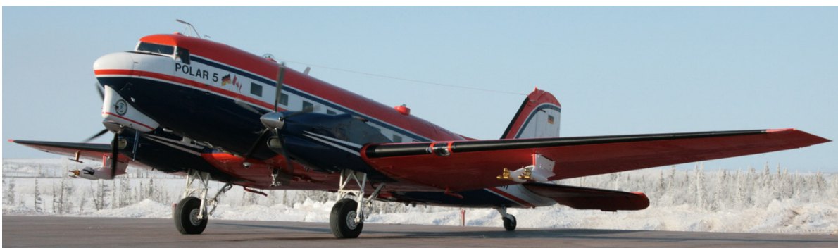
Abbildung 2.3 – Das Forschungsflugzeug POLAR 5, mit unter den Tragflächen montierten Flügelsonden, wurde während der VERDI Kampagne als Messplattform eingesetzt.
